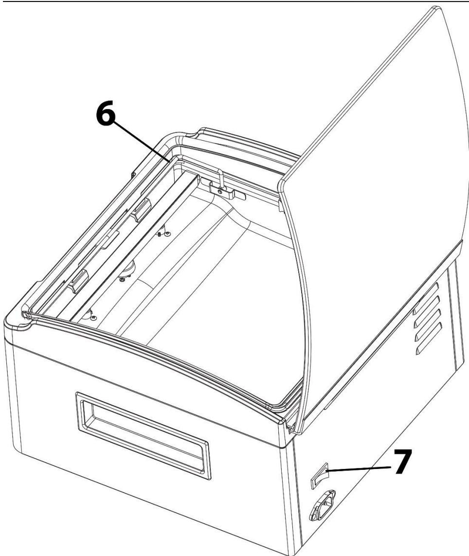
**6 Фиксатор:** фиксирует пакет во время вакуумирования и запечатывания.
