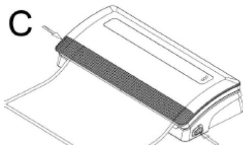
5. Если процесс сваривания завершился (светодиод 11), нажмите обе кнопки запоров (2) (рис. С), откройте крышку и выньте пакет.
