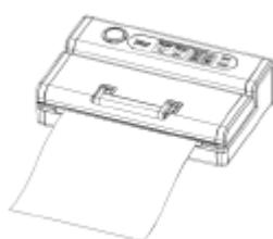
Закройте крышку, сильно нажав на ручку так, чтобы послышалось два щелчка.
