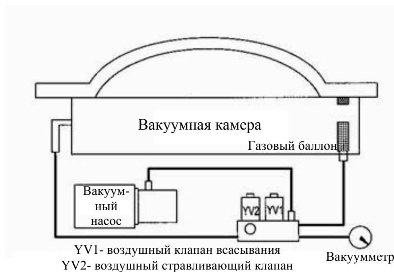
Схема вакуумного упаковщика с производительностью вакуумного насоса 10 м 3
