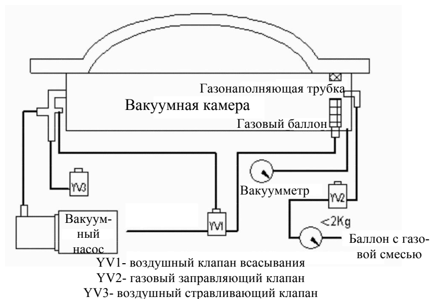
Схема вакуумного упаковщика с системой газации
