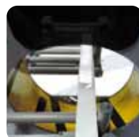
Doppia testata portabobina film Doppelte Folienvollenaufnahme Одновременная работа с двумя рулонами пленки
