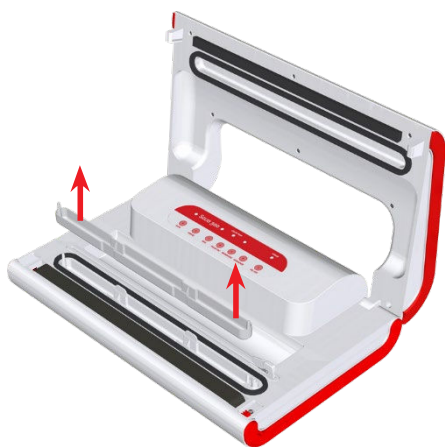
Рисунок 6: Если жидкость попала в вакуумный канал, поднимите лоток ловушки для жидкости прямо вверх, вылейте жидкость и тщательно высушите лоток.
