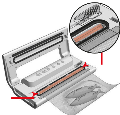
Рисунок 4. В процессе вакуумной упаковки край пакета должен находиться посередине вакуумного канала.
