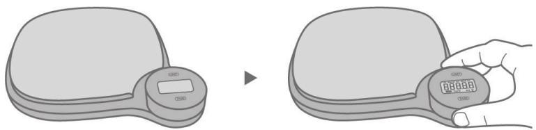
Поворачивайте регулятор по часовой стрелке до тех пор, пока на дисплее не появится значение 0. После этого Вы можете зарядить прибор, используя генератор.
