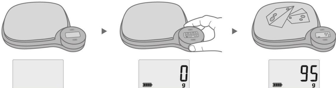
Поместите весы на твердую и ровную поверхность. Поворачивайте регулятор по часовой стрелке до тех пор, пока не увидите на дисплее значение 0. Поместите продукты на весы и их вес отобразится на дисплее.
